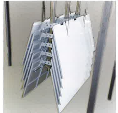
傾斜状態 (スラッジ滑落時)
